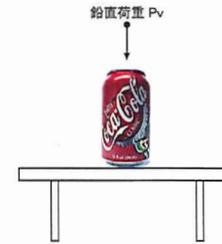
上図のように物体  $m$  に鉛直荷重  $P_v$  という外力が作用した場合、「力の釣り合い法則」に基づき、物体  $m$  にはテーブルからの反力  $R_v$  が下図のように作用し、物体  $m$  は静止状態を保ちます。(よは動かないってことね。)
