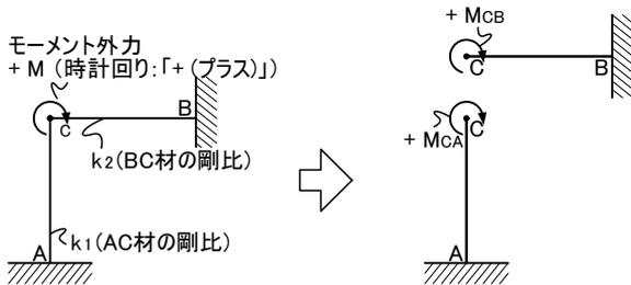
上図のような不静定構造物にモーメント外力 M が作用した場合について考えましょう。この場合モーメント外力 M は、右図のような内力 M<sub>CA</sub>、M<sub>CB</sub> に分割され、AC材、BC材の内力伝達を受けます。
