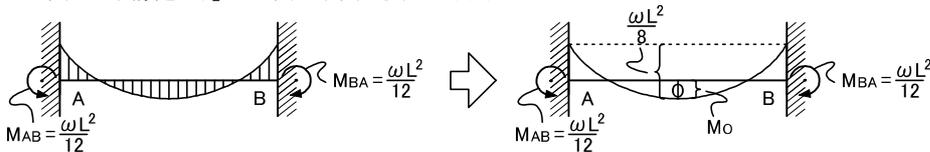
上図の「固定端」におけるモーメント反力  $\frac{\omega L^2}{12}$  は暗記しておいて下さい。
